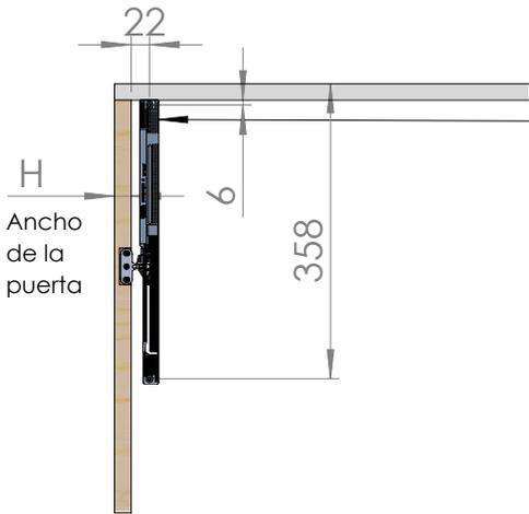
Paso 3: Colocar el sistema de cierre enrasado al borde y a una profundidad "H" + 22mm, posteriormente fijar la pieza con dos tornillos
