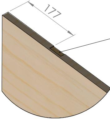
Paso 1: Mecanizar en la puerta una ranura rectangular de 44 x 14 mm y con una profundidad de 2 mm como se aprecia en la imagen.
